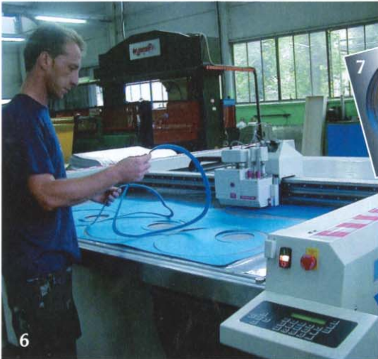
6 - Produzione di guarnizioni 7 - Guarnizioni a base di Thermiculite®: uno dei materiali più innovativi della società Flexitallic, di cui Euroguarco è distributore per l'Italia
